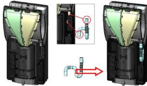
Introducir el extremo del nuevo tubo marcado como "máquina" a través del agujero de la trasera y fijarlo en la salida de agua de la máquina. Para ello NO quitar la parte sobrante de la manguera original.
